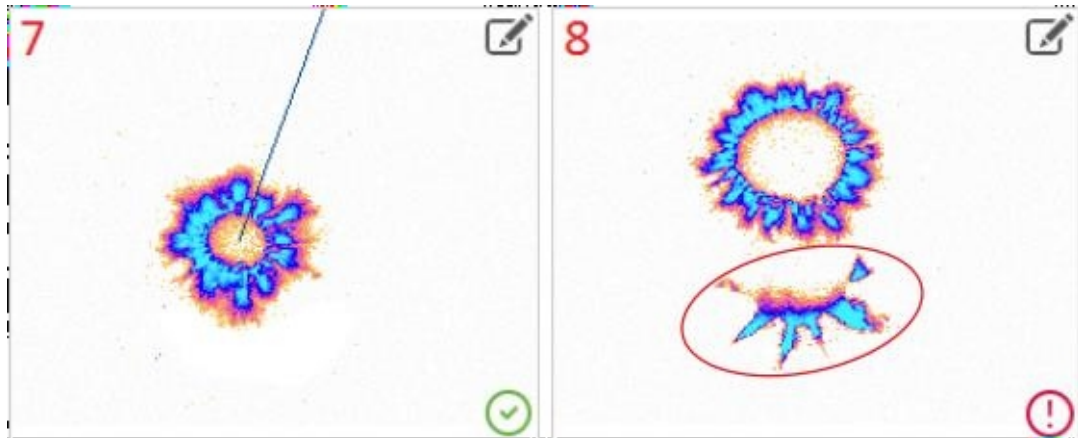
Foto 25. 7 - presión demasiado baja (la elipse inscrita es demasiado pequeña); 8 - luz externa en la parte inferior que debe ser borrada (para editar - haga clic en el signo del lápiz en la esquina superior derecha de la imagen o simplemente haga doble clic en cualquier lugar de la imagen).
